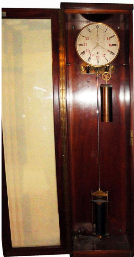
7. Reloj Fénon N° 195, se aprecia la esfera, la pesa impulsora y el péndulo con su peso (MOA, S. Paolantonio 2012).
