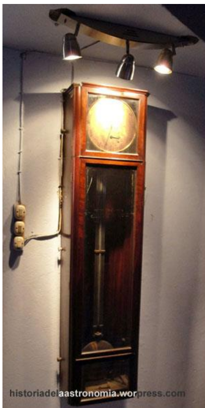
2. Reloj Tiede N° 373 y detalle de su esfera. En el centro de la aguja del dial horario se introduce una pequeña manija que permite subir la pesa. (MOA, S. Paolantonio 2012) Dimensiones: Gabinete de madera (caoba): ancho 30,5cm, alto 125cm, prof.: 17,5cm Diámetro de la esfera: 21 cm
