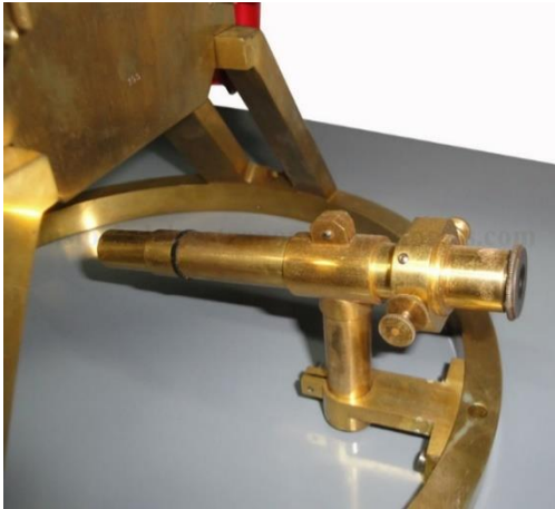
12. Detalle del microscopio para controlar la posición del péndulo (MOA, S. Paolantonio 2011).
