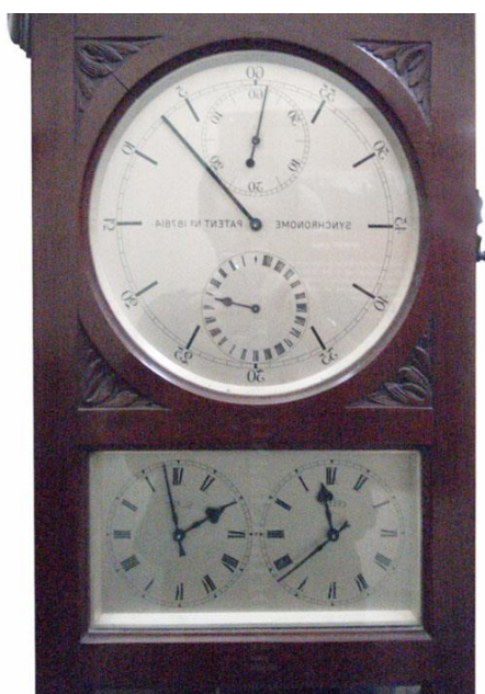
33. Detalle de la esfera del reloj esclavo que sirve al Shortt N° 55 (MOA, S. Paolantonio 2008).
