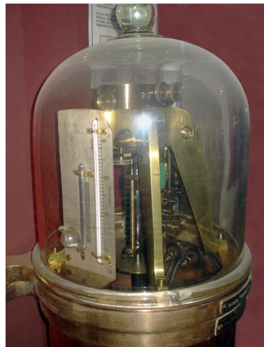
30. Tres vistas de la máquina del Reloj Shortt N° 55 del Observatorio Nacional Argentino. Dentro de la campana hay un termómetro (grados Celsius) y un barómetro de mercurio. Dimensiones: Campana : diámetro 21 cm, alto: 25 cm, Alto total : 125 cm (MOA, S. Paolantonio 2008).
