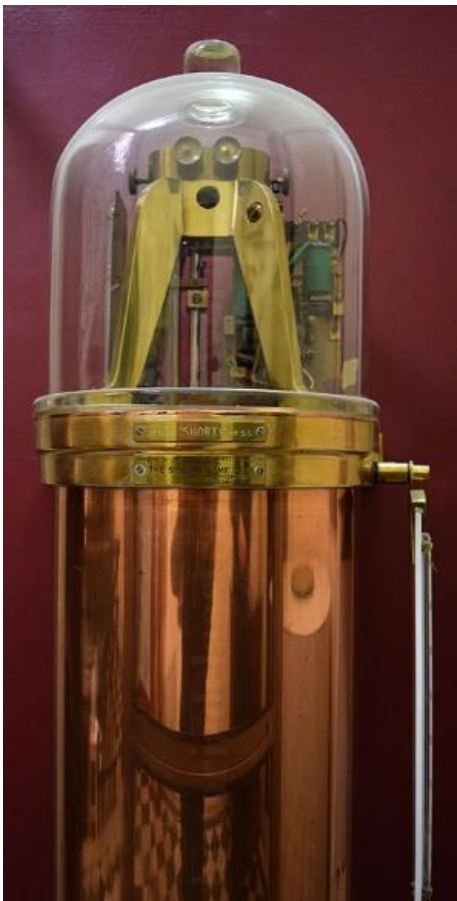
29. Reloj patrón Shortt N° 55 del Observatorio Nacional Argentino. Abajo, detalle de las placas que lo identifican (MOA, S. Paolantonio 2015/08).
