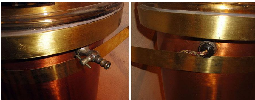
26. Riefler N° 330. Izquierda, boquilla a la que se conectaba la bomba de aire manual para hacer vacío en el interior del recipiente. Derecha, salida de los cables destinados a la alimentación, sincronización con el reloj esclavo y el control del cronógrafo (MOA, S. Paolantonio 2012).
