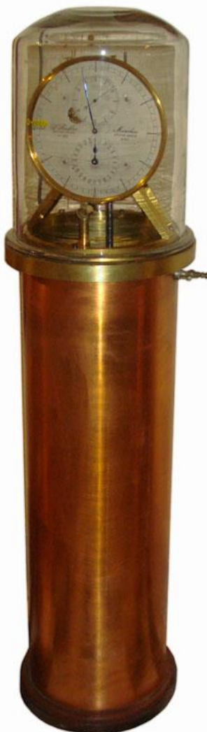
22. Riefler N° 330 del Observatorio Nacional Argentino. El péndulo se encuentra contenido en el recipiente cilíndrico. Campana : Ø 31 cm, alto: 41 cm. Alto total : 141 cm. (MOA, S. Paolantonio 2011).
