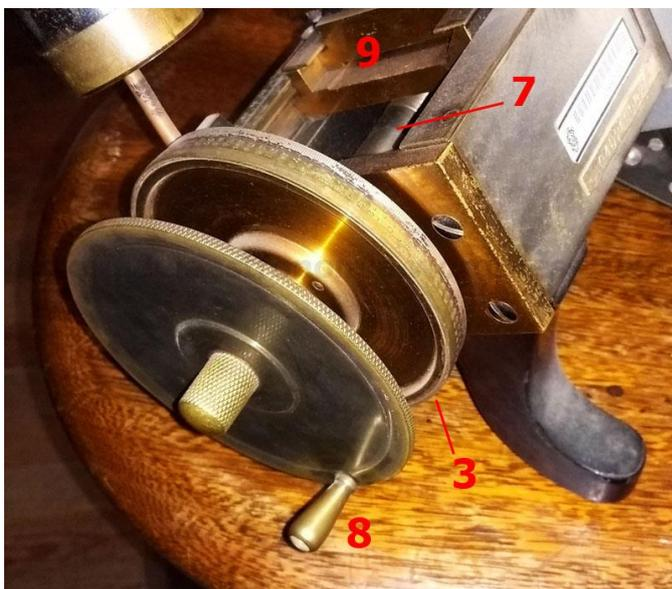
La manija (8) ubicada en una rueda con bordes moleteados, permite girar el tornillo micrométrico (7) que mueve el carro con la platina porta placa (9). El desplazamiento se mide con la rueda (3) (S. Paolantonio).
