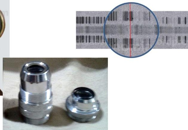
Fuera de las escalas y los tornillos que están con seguridad fabricados en milímetros, el instrumento en general parece haber sido construido con base en el sistema inglés de medidas, en pulgadas.
