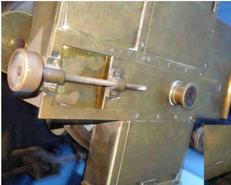
30. Detalle del sistema que posibilita el desplazamiento lateral del ocular del micrómetro. Nótese la escala (0-80 mm).
