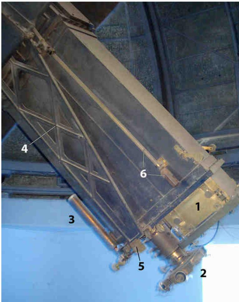
**23.** Extremo del tubo del astrográfico con el soporte del chasis porta placa (1) y el micrómetro (2). El “buscador” (3) es un pequeño telescopio de gran campo, que facilita ubicar el área a fotografiar (figura 37); (4) “brazo” del movimiento fino en declinación y (5) su mecanismo de accionamiento (figuras 31 y 32); (6) freno del telescopio en declinación (Foto S. Paolantonio, 2011).
