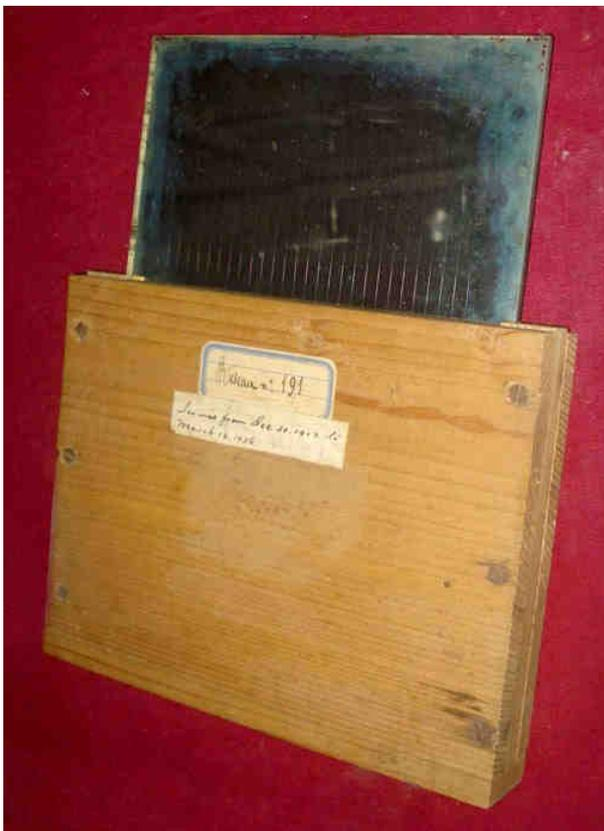
**2.** Réseau N° 191. Con anterioridad a cada exposición, se imprimía sobre la placa un “reseau”, consistente en un reticulado con líneas separadas cada 5 mm, que cubría un cuadrado de 130 x 130 mm (área útil). Se utilizaba como referencia para la posterior medición. A lo largo de los trabajos para la Carte du Ciel realizados en Córdoba se emplearon 6 réseau, con los siguientes números de serie: 106 (roto), 116, 119, 126 (roto), 182 y 192 (Paolantonio y Minniti, 2009).
