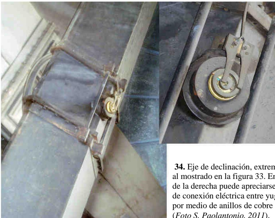
**34.** Eje de declinación, extremo opuesto al mostrado en la figura 33. En el detalle de la derecha puede apreciarse el sistema de conexión eléctrica entre yugo y tubo, por medio de anillos de cobre y escobillas (Foto S. Paolantonio, 2011).
