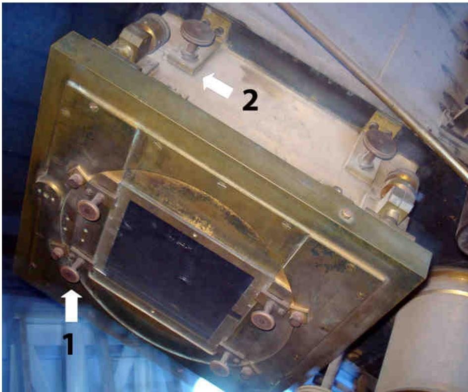
25. Conjunto del soporte del chasis porta placa. El chasis se sujeta por medio de 4 trabas (1). Pueden apreciarse los elementos destinados a la regulación de la posición del soporte (2) (detalle en figura 26) (Foto S. Paolantonio, 2011).
