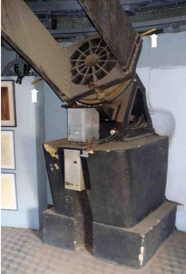
**39.** Pilar norte. Las flechas señalan manijas que facilitan el movimiento manual del telescopio en ascensión recta. La gran mayoría de los astrográficos no cuentan con estas manijas, fuera de Córdoba, aparentemente solo el de Toulouse las tiene. Las cajas de aluminio contienen el motor paso a paso, engranajes y electrónica que reemplazan al sistema original de relojería (figura 22) (Foto S. Paolantonio, 2011).
