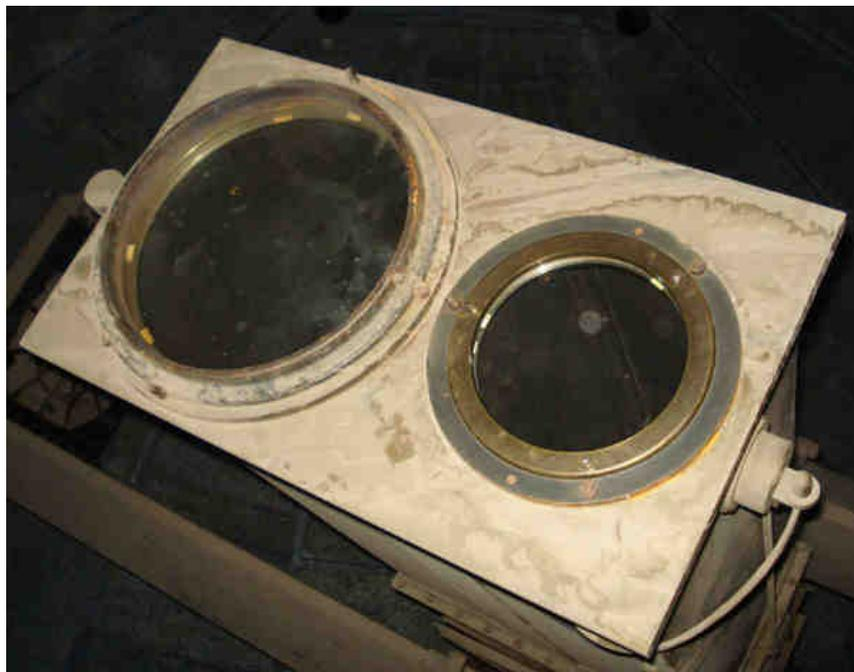
5. Los objetivos del astrográfico están montados sobre una placa metálica atornillada al extremo del tubo de sección rectangular, el mayor (izquierda) objetivo fotográfico (d: 33 cm), el menor (derecha) objetivo del anteojo guía (d: 19 cm). Internamente el tubo está dividido en dos longitudinalmente por una chapa, pintado en negro mate. (Foto S. Paolantonio, 2011).
