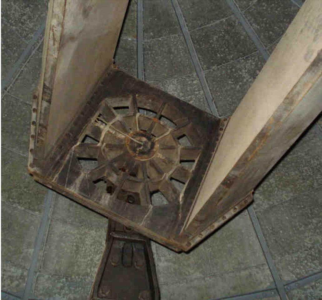
**44.** Extremo sur del yugo, también formado de fundición de hierro. El soporte del eje es metálico (identificado con 2 figura 46) (Foto S. Paolantonio, 2011).
