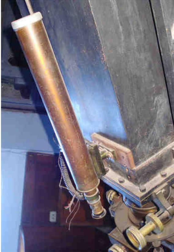
**37.** Detalle del “buscador” (objetivo de 50 mm de diámetro) y la iluminación (1) del retículo ubicado en el plano focal del ocular (2). La perilla (3) permite variar la iluminación del campo del micrómetro (figura 20) y la (4) corresponde al movimiento fino en declinación (figuras 31 y 32) (Fotos S. Paolantonio, 2011).
