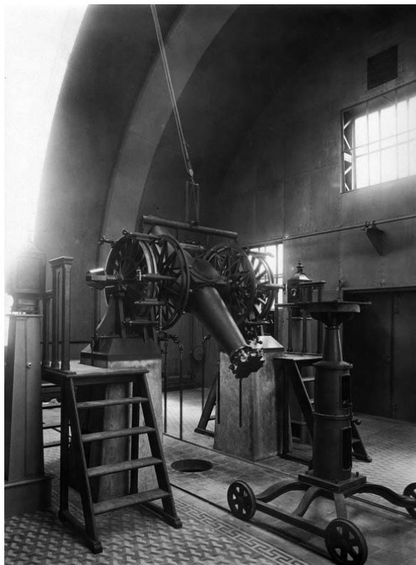
5. El círculo meridiano Gautier. El carro que se puede apreciar a la derecha permite el giro en 180^\circ del eje de declinación. Un instrumento similar contaba el Observatorio Astronómico de La Plata. (Biblioteca OAC)
