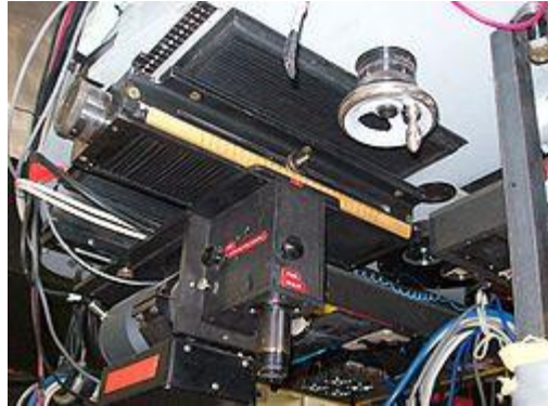
Controles de movimiento y sensores del telescopio en su parte inferior – Im. OAFA
